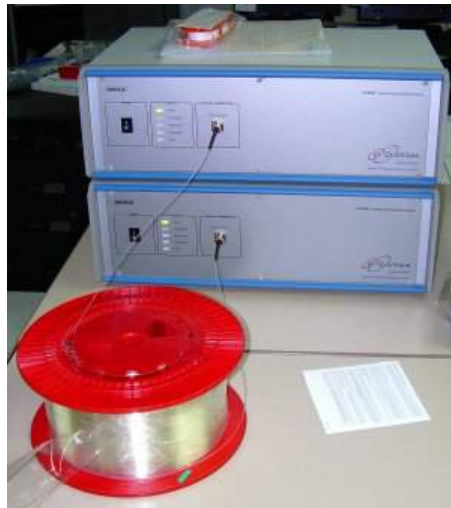
Figura 3.17: Los equipos QKDS-A y QKDS-B del sistema id-3000, y el rollo de fibra de 12,6 Km utilizado en las pruebas de laboratorio.
