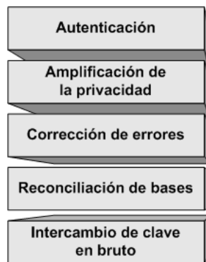
Figura 4.1: Arquitectura en niveles de un sistema QKD.
